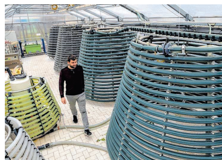
In sogenannten Tannenbaumreaktoren werden im Biosolarzentrum der Hochschule Anhalt in Köthen Algen kultiviert.
